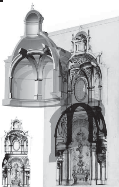
Figura 14. Gli archi intrecciati di B. Vittone. B. Vittone's arches.
